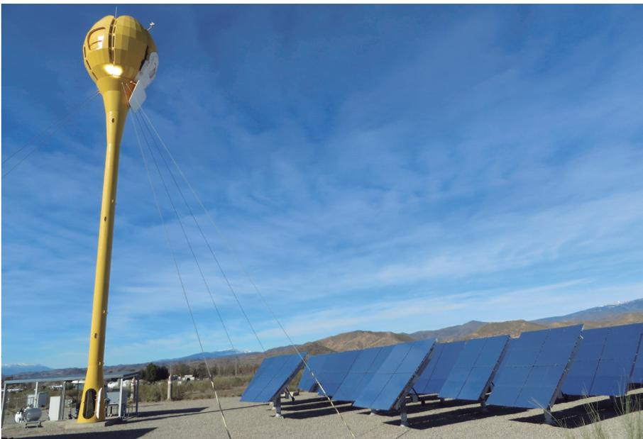
Prueba de concentración de un heliostato para un sistema de torre solar de generación directa de vapor.
