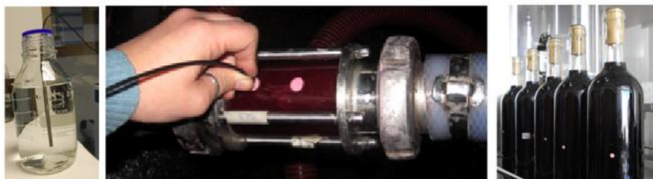
Fig 4: Sensores ópticos PreSens® para medición de oxígeno (A) al interior de un recipiente utilizando sondas de profundidad (dipping probe), (B) durante el movimiento de líquidos a nivel industrial, empleando visores en los cuales se adhiere el sensor tiene forma de punto (dot) y (C) después del embotellado empleando sensores tipo dot, para mediciones en el headspace y el líquido.
