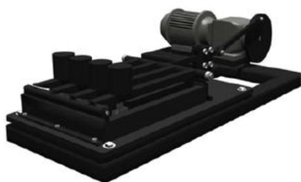
Figura 1: Máquina Miller, aparato usado para el desgaste de las muestras de acero
