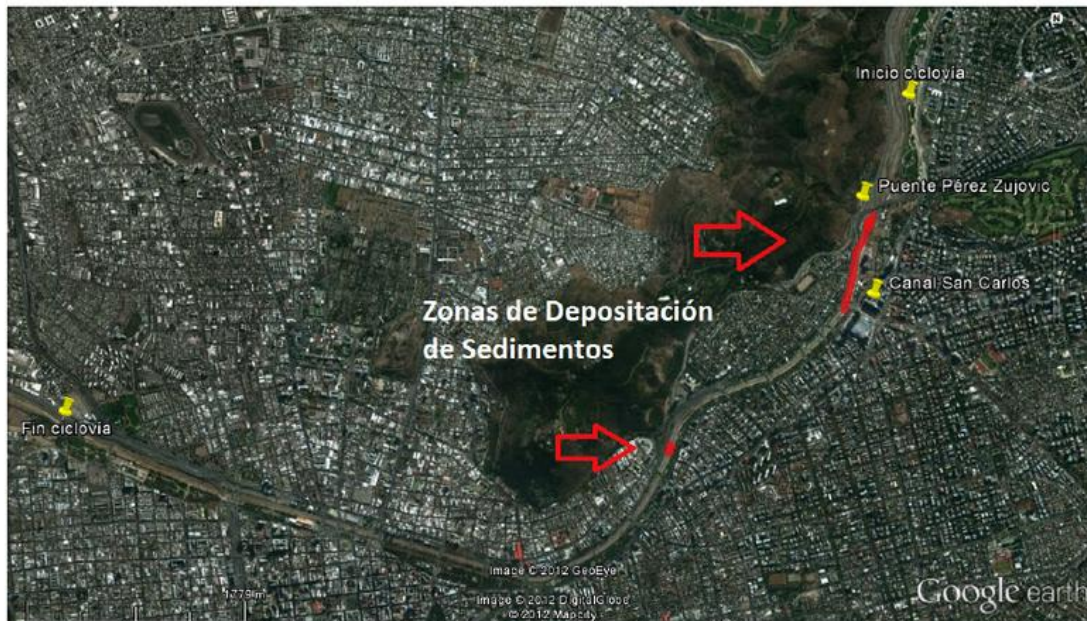
Figura 2: Tramo del río en que se construirá la ciclovía en el cauce del río Mapocho con indicadas zonas de probable deposición de sedimentos de acuerdo al modelo. Sobre imagen de © Google 2012 [4].
