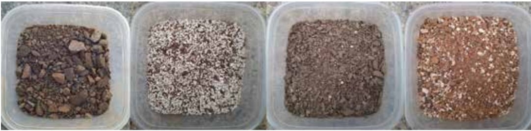
Figura 2. Sustratos analizados. De izquierda a derecha: LIVE, perlita, tierra de hoja y ladrillo.
