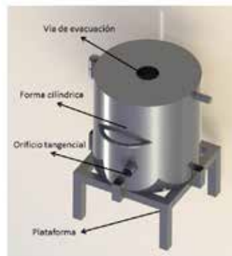
Figura 3. Estructura metálica del horno.
