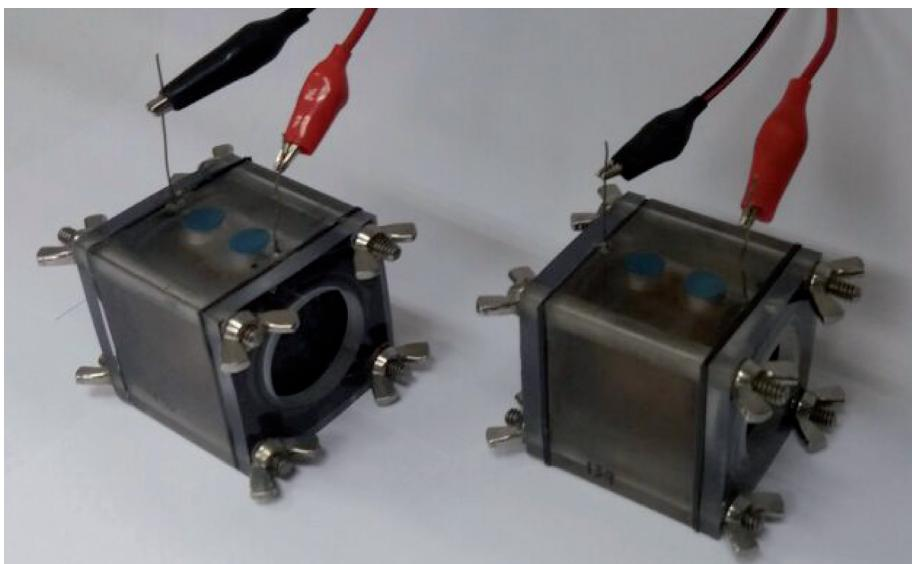
**Figura 1.** Fotografía de las MFCs operadas bajo condiciones ácidas, con Piruvato como donante de electrones y oxígeno como acceptor.
