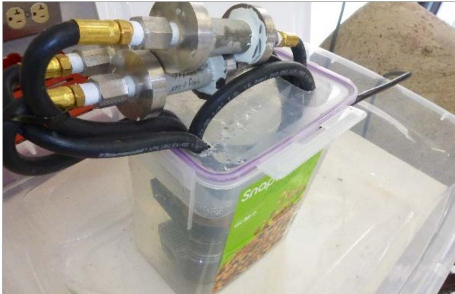
**Figura 3.** Autocurado de probetas de mortero.
