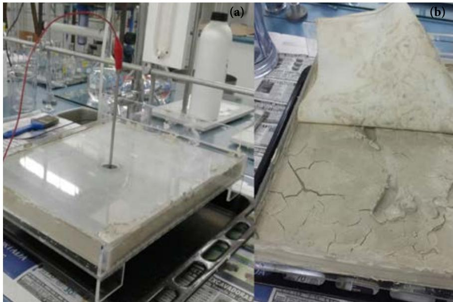
**Figura 2.** Prototipo escala laboratorio DEO. (a) Prototipo armado previo a la operación. (b) Prototipo tras operación, se observan grietas debido a la reducción de humedad.
